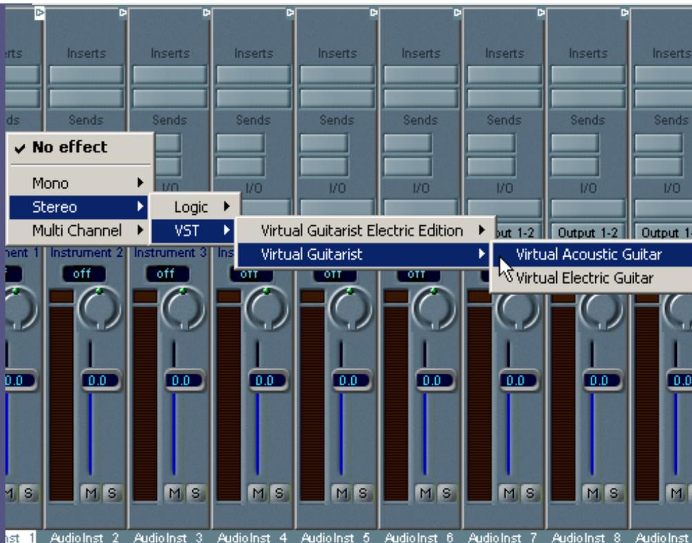
При работе с Virtual Guitarist Electric Edition процессор эффектов отдельно назначать не требуется, хоть он и стоит следующим в списке доступных модулей (рис. 10), так как процессор уже интегрирован в инструмент. Зато если есть желание воспользоваться этим процессором для обработки аудиотреков или "повесить" его на других "Гитаристов" (Virtual Acoustic и Virtual Electric), вы включаете его в соответствующий разрыв, как самый обычный VST-модуль эффектов.
