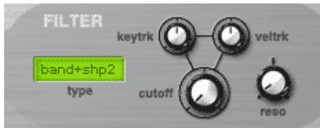
VANGUARD имеет 13 различных типов фильтров, включая стандартные низко и высоко частотные фильтры, а так же их разновидности. Для выбора фильтра надо нажать на зеленое поле указателем мыши и мы получим список всех 13 доступных типов фильтров. Блок фильтра имеет четыре регулятора:
