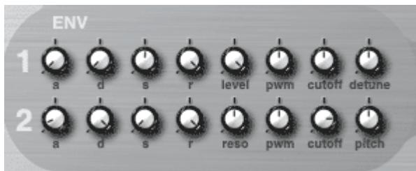
VANGUARD предлагает две огибающие обозначенные цифрами "1" и "2". Здесь использованы классические огибающие типа a.d.s.r. Разберемся поподробнее что же все эти регуляторы означают:
