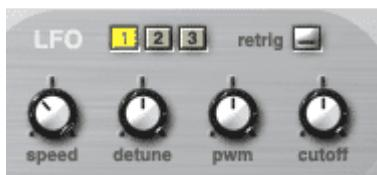
Далее с права находится блок LFO - генератора низкой частоты, здесь имеется три независимых генератора. Переключение между генераторами осуществляется нажатием клавиш соответственно 1-это первый генератор и так далее до третьего. Генератор имеет четыре регулятора:
