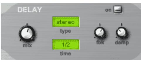
Блок задержки здесь представлен в классическом варианте. Если вы уже работали с эффектом delay - то все вам здесь должно быть знакомо. Регулятор "mix" - отвечает за смешивание прямого и задержанного во времени сигнала. Так же есть возможность выбрать один из четырех "type" типов задержки: "mono", "stereo", "widen" и "cross".
