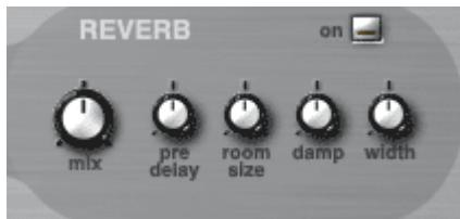
Эффект реверберации эмитирует распространение звука в каком либо помещении, то есть отражение сигнала от стен. Этот блок так же представляет классический ревербатор. Назначение органов управления:
