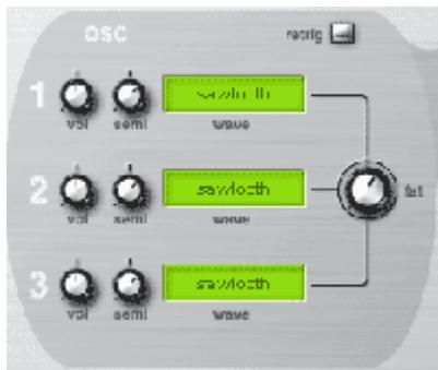
Каждый имеет свою настройку уровня сигнала "vol" и регулировку полутонов "semi" от -36 до +36 полутонов (-/+ 3 октавы). Форма волны выбирается нажатием на зеленое окошечко с права от регуляторов. Выбор первой формы волны "---" выключает генератор, всего доступно 31 форма волны.
