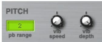
В этой секции можно настроить действия колеса pitch на вашей midi клавиатуре - если конечно у вас есть. Регулятор "pb range" - устанавливает диапазон сдвига тона при прокручивании колеса на полный оборот, можно выставить значение от 0 до 12 полутона.
