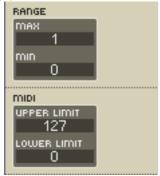
Чтобы достигнуть оптимального управления модулем, для модулей этих двух типов диапазон управляющего сигнала масштабируется между **Min** и **Max** (эти значения устанавливаются в окне свойств модуля).
