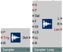
Каждый модуль-семплер имеет ввод **P(itch)**, который используется для выбора семпла из карты и для контролирования высоты тона семпла. Обычно этот ввод соединяется с модулем Note Pitch, который посылает текущую MIDI-ноту. Когда семпл вызван в режиме мультисемплинга, по значению полученному на **P(itch)** порт модуль выбирает необходимый семпл и его транспонирование.
