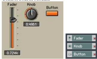
**Fader**, **Knob**, **Button** – вот примеры модулей источника контролирующего сигнала. Есть два пути создания таких модулей: через общее контекстное меню окна (в подменю **Built-In Modules/Panel**), а также используя контекстное меню порта входа (**Create Control**). Вид и размер фейдера можно назначить в свойствах модуля. Контекстное меню такого модуля включает уже известные команды: **MIDI Learn**, **Cut**, **Copy**, **Duplicate**, **Delete** и **Properties**.
