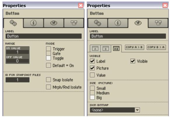
Кнопки работают в качестве переключателей. У этого объекта панели в свойствах устанавливаются два значения: **On Value** и **Off Value**. Вы можете переключать кнопку кликая по ней мышью. Также можно переключать кнопку по MIDI.
