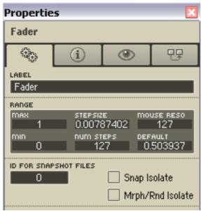
**Регуляторы** (фейдеры **Faders** и регуляторы круглого типа **Knob**). Это контроллеры панели, параметры настройки которых задают значения портов вывода их исходных модулей в структуре. Диапазон возможных значений устанавливается в свойствах: **Min** и **Max**. Там же устанавливается разрешение шагов (**Stepsize**) и разрешающая способность мыши (**Mouse Reso**) – расстояние, которое должен пройти курсор мыши для того, чтобы изменить значение.
