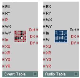
Такие модули – очень гибкий инструмент работы с аудиоданными и событиями. Их можно использовать для разработки осцилляторов, LFO или waveshapers, рисуя собственные типы волн мышью. Также можно создать пересечение между двумя wavetables (таблицами волн), создать огибающие с нарисованными вручную кривыми формами или с бесчисленными контрольными точками. Модуль **Event Table** может быть использован как секвенсор для значений gate и pitch или для контролирования параметров в ансамбле Reaktor.
